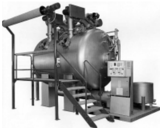
Figure 14. THEN사의 Air-Flow 고압염색기.
